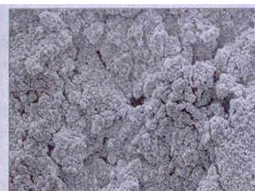
Sulfatkristalle einer zwei Jahre alten reaktivierten Lagerbatterie nach der Puls-Kur.
